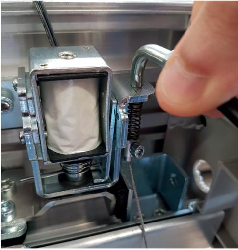
Compruebe el funcionamiento del desbloqueo manual, cuando la manilla está en posición bloqueada, el electrobloqueo debe funcionar normalmente.
