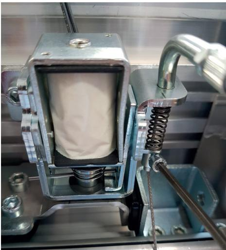
Posicione el resorte de compresión e introduzca el cable metálico a la altura del ancla de desbloqueo, luego lo bloquee con la abrazadera de tornillo.
