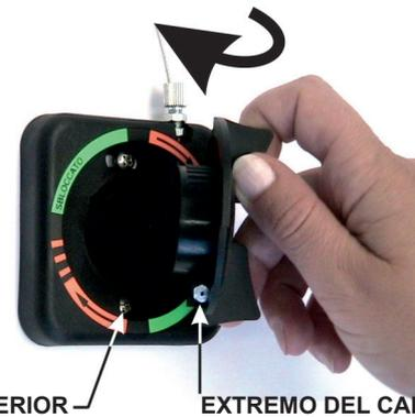
Ahora introduzca la manilla de desbloqueo en el fondo del mecanismo prestando atención a mantener el extremo del cable en el receptáculo del bloqueo del cable y la manilla en correcta posición. Al introducir la manilla el extremo del cable debe encontrarse en posición justo después, en sentido horario, del tornillo inferior de fijación.
