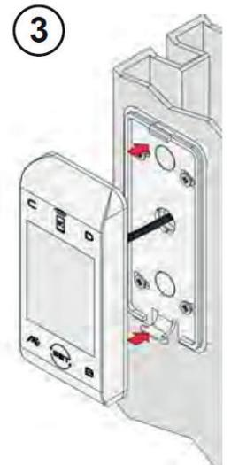
Conectar el otro terminal del cable al conector J7 de la centralita ET-LOGIC EASY 70.
