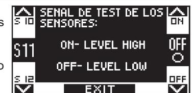
Configuración del contacto en la entrada OPEN entre los bornes 18-19 de la tarjeta ET-LOGIC-B.
