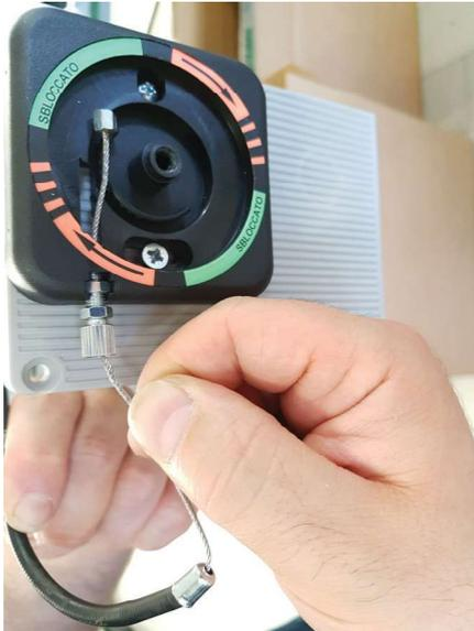
Introduzca el cable de acero dentro de la manilla de desbloqueo y de la vaina hasta que se alcance el electrobloqueo.
