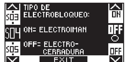
Seleccione ON si se ha instalado un sensor de seguridad en cierre (entre los bornes 2-3).
