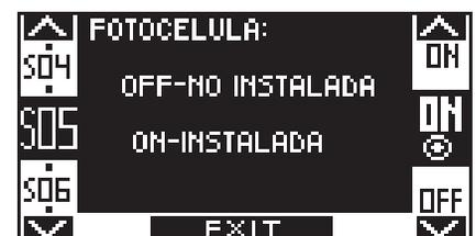
Seleccione ON si se ha instalado un sensor de seguridad en apertura (entre los bornes 5-7). Se aconseja regular el campo de detección del sensor de seguridad antes de iniciar la configuración, para que el operador pueda memorizar con precisión la posible presencia de la pared lateral.
