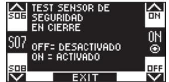
Solo si la función S06 se ha configurado en ON
