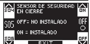
Seleccionar ON solo si se ha instalado un sensor de seguridad en apertura en la entrada E.O. (borne 6)
