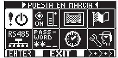
Escriba la contraseña técnica de 10 caracteres para acceder a la configuración. La contraseña técnica por defecto con la cual Label suministra el programador digital ET-DSEL es "A-A-A-A-A-A-A-A-A-A"
