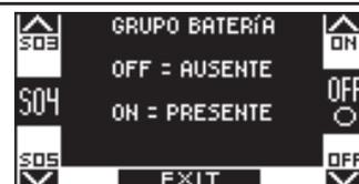
Seleccionar ON solo si se ha instalado un sensor de seguridad en cierre en la entrada E.C. (borne 7). La selección de esta función es válida tanto para la automatización master como slave.
